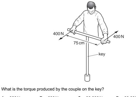
**A** 300 Nm **B** 600 Nm **C** 30 000 Nm **D** 60 000 Nm
